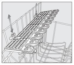
Schieben Sie den Gläserhalter in die gewünschte Höhe, bis die Befestigungen oben oder unten einrasten. Mit den MultiClips können Sie leichtes Spülgut auf dem Gläserhalter befestigen, z. B. Kunststoffteile.
