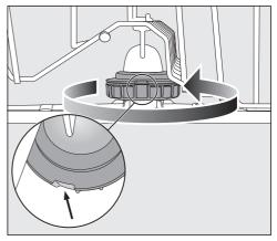
■ Setzen Sie den mittleren Sprüharm wieder ein und drehen Sie die Verschraubung gegen den Uhrzeigersinn (Blickrichtung von oben), bis sie einrastet. Achten Sie darauf, dass die Aussparungen in der Verriegelung übereinander liegen.
