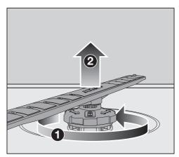
■ Drehen Sie die Verschraubung des unteren Sprüharms gegen den Uhrzeigersinn ① (Blickrichtung von unten) und ziehen Sie den Sprüharm nach oben ab ②.
