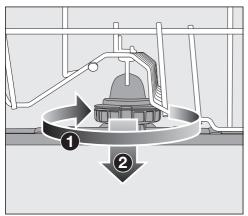
Drehen Sie die Verschraubung des mittleren Sprüharms im Uhrzeigersinn (Blickrichtung von oben) und nehmen Sie den Sprüharm ab (2).
