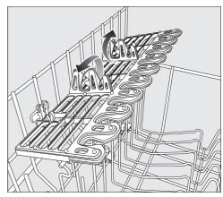
■ Klappen Sie die MultiClips hoch.
