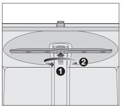
■ Drücken Sie den oberen Sprüharm hoch ①, damit die innere Verzahnung einrastet, und schrauben Sie ihn gegen den Uhrzeigersinn ab ② (Blickrichtung von unten).
