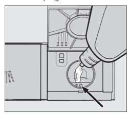
■ Füllen Sie nur so viel Klarspüler ein, bis sich die Füllstandsanzeige (Pfeil) bei waagerecht geöffneter Tür dunkel verfärbt.
